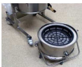
Schmutzbehälter mit Filterstufe 2
