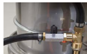
Druckluftverteilung bei Gebrauch mit Druckluftmembranpumpe
